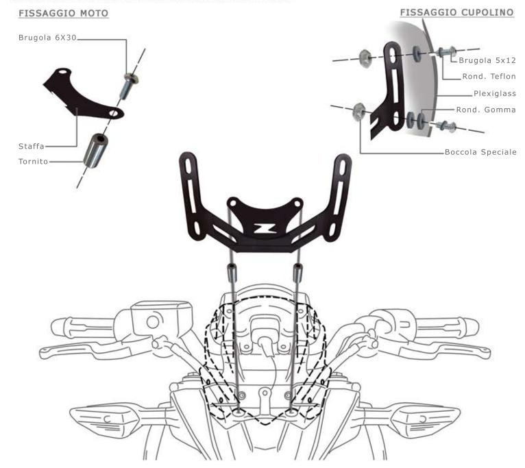
NOTE: NON SERRARE IN MODO ECCESSIVO ONDE EVITARE ROTTURE DEL PLEXIGLASS.
