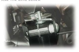
MOUNT THE WINDSHIELD/SCREEN WITH THE "L" STIRRUP ALREADY ON IT. USE THE LARGE WASH-ERS AND THE BLIND NUT LIKE SHOWN IN THE PICTURE. FIND THE IDEAL POSITION AND LOCK ALL THE SCREWS
