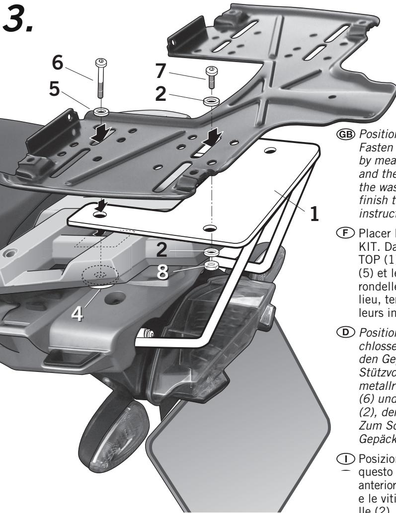
(E) Posicionar la parrilla (D1B50PM) no incluida en este KIT. En la zona delantera fijarla al soporte KIT TOP (1) mediante las arandelas especiales (4), las arandelas (5) y los tornillos (6) y en zona posterior mediante las arandelas (2), los tornillos (7) y las tuercas (8). Por último acabar de montar la parrilla (D1B50PM) según sus instrucciones.
