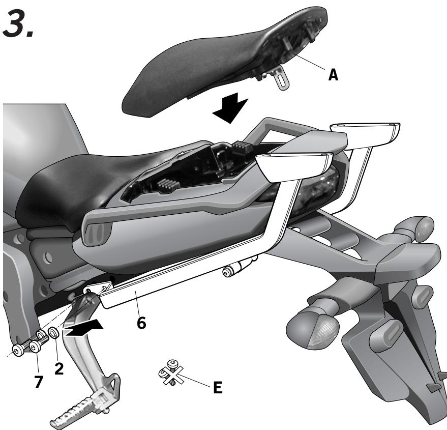
(E) Desmontar las estriberas traseras mediante los tornillos (E) que se desestiman. Montar el soporte KIT TOP (6) entre el chasis de la moto y las estriberas, mediante los tornillos (7) y las arandelas (2).
