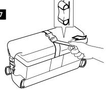
Achten Sie darauf, dass die Überlängen der Riemen gegen Flattern gesichert werden.
