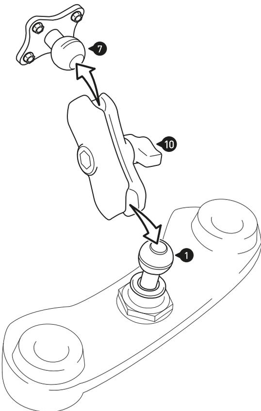
Öffnen Sie den RAM-Arm (10) und verbinden Sie die Gelenkkugel (7) mit dem Kugel Adapter M8 (1).
