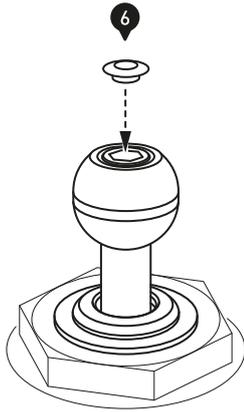
Setzen Sie die Kunststoffkappe [6] in den Schraubenkopf ein.
