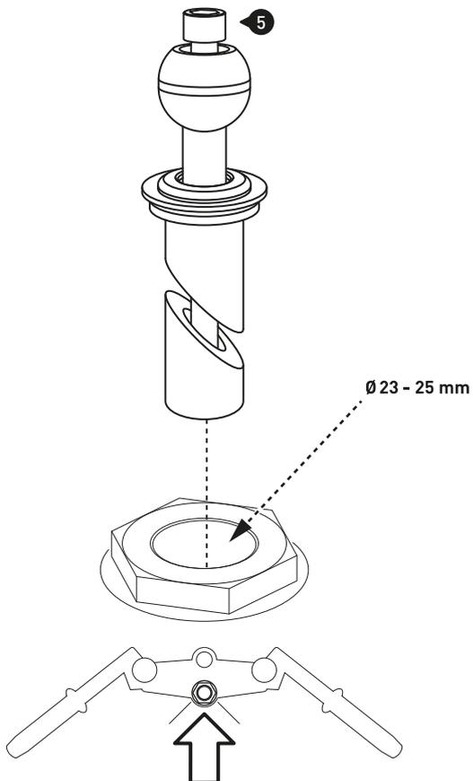
Setzen Sie die verschraubte Einheit in die Öffnung der Mutter des Steuerkopfrohrs ein (Durchmesser: 23 - 25 mm). Ziehen Sie anschließend die Schraube (5) an, bis die Einheit fest in der Öffnung sitzt.
