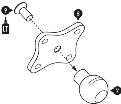
Verschrauben Sie den Universal-Halter (8) mit der Gelenkkugel (7).
