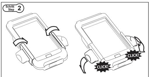
Achten Sie darauf, dass beim Schließen die Feder des Deckels in der Nut der Silikoneinlage liegt, da sonst der Spritzwasserschutz nicht mehr besteht.
